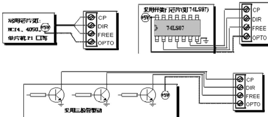
◆ 控制系统共阴输出与共阳方式驱动器连接图:
