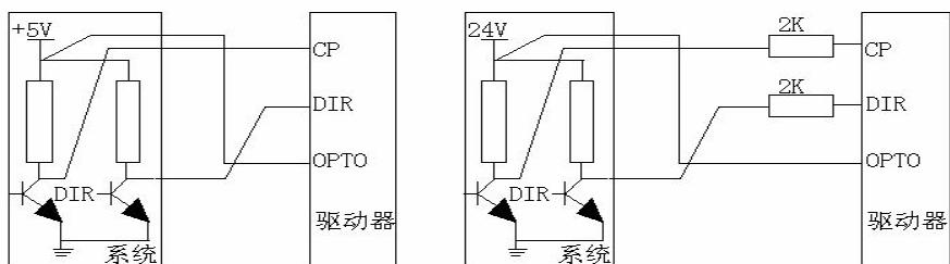
◆ 西门子 PLC (S7 CPU226), 与共阳驱方式驱动器连接图:
