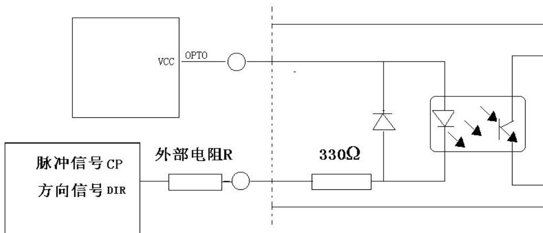
如果输入电压超过 5V，串接外部电阻 R 限流。
